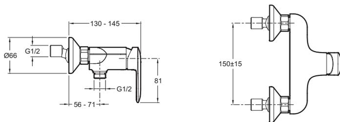
Спецификация продукта: Однорычажный настенный смеситель для душа. E99463. Коллекция: KUMIN. Расход воды: 13 л/мин. Механизм: Керамический картридж с чувствительным ограничителем расхода воды. Разметка отверстий: 150 +/- 15 мм.
