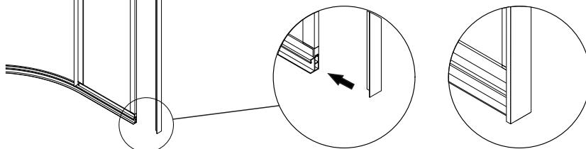
7. В установочном профиле просверлите три сквозных отверстия для крепления к стенам. Приложите установочный профиль к стене, нанесите разметку через просверленные отверстия (рис. 8). По разметке просверлите в стенах отверстия, установите в них дюбели (рис. 9).
