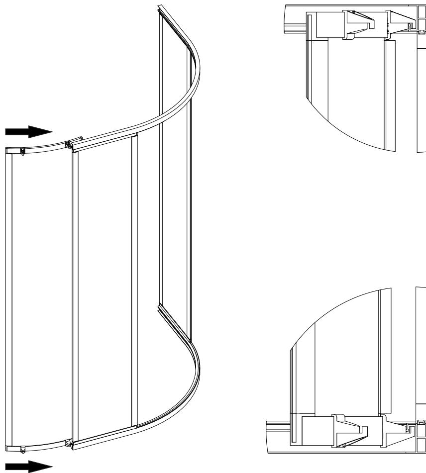
5. К дугам каркаса шурупами прикрутите демпферы согласно нанесенной разметке (рис. 6).
