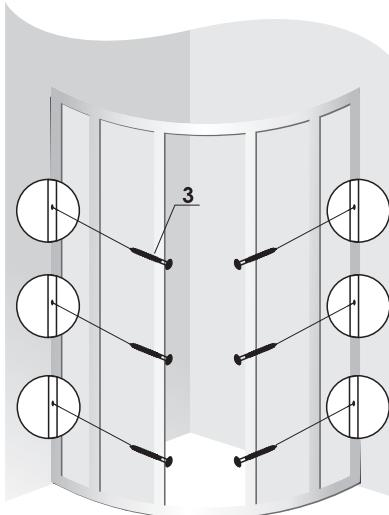
9. Нанесите герметик на душевой поддон в месте установки ограждения, установите ограждение, заправив панели в установочный профиль.
