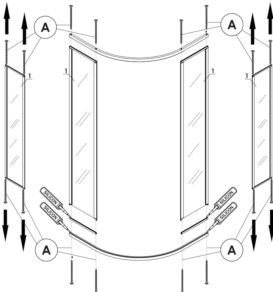
2. Закрепите дуги каркаса к панелям выкрученными на предыдущем шаге шурупами. В местестыковки нижней дуги и панели нанесите герметик. После сборки уберите излишки герметика тканью.
