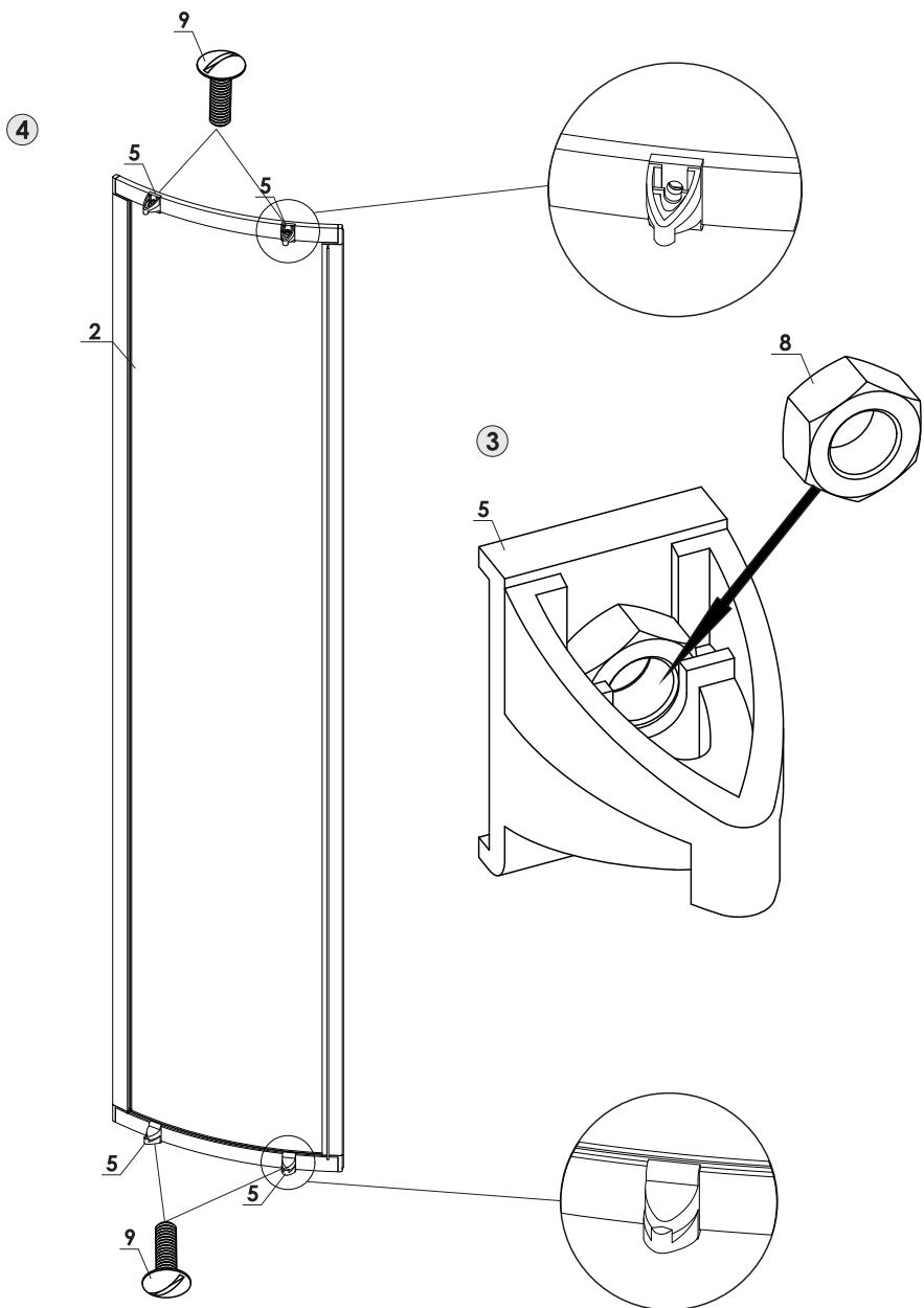
4. Заправьте дверцы в дуги каркаса, одновременно заводя верхнюю и нижнюю петли в зацепление с дугой (рис. 5).
