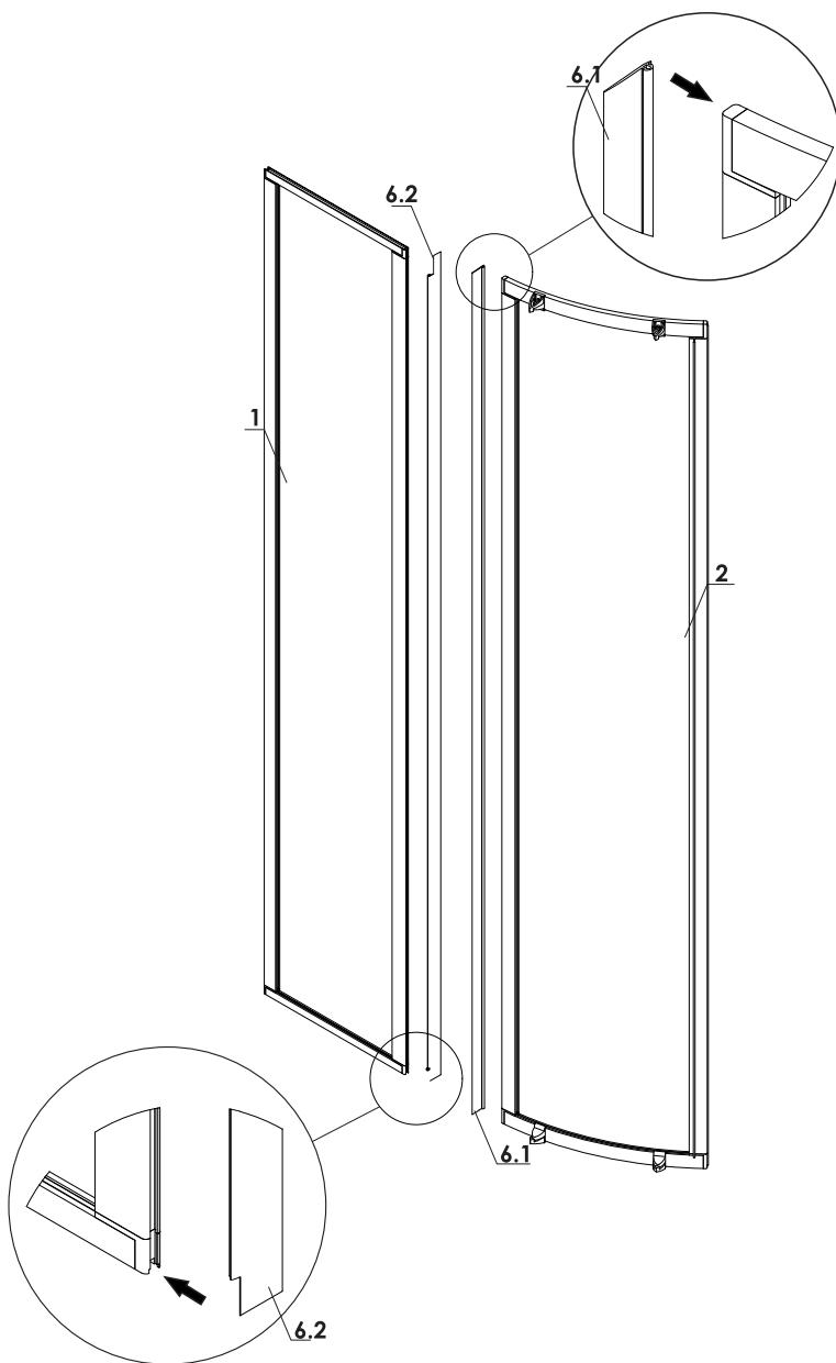
6. Оденьте установочный профиль на изделие (рис.7). Поставьте душевое заграждение по месту установки, нанесите разметку в местах крепления к стенам. Используйте строительный уровень.
