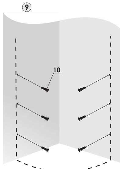
8. Нанесите герметик на установочный профиль, закрепите его к стене шурупами (рис. 10)
