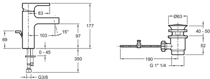
Спецификация продукта: Однорычажный смеситель средней высоты для раковины. E37327. Коллекция: STRAYT. Вес: 2,8 кг. Расход воды: 5 л/мин. Механизм: Керамический картридж.
