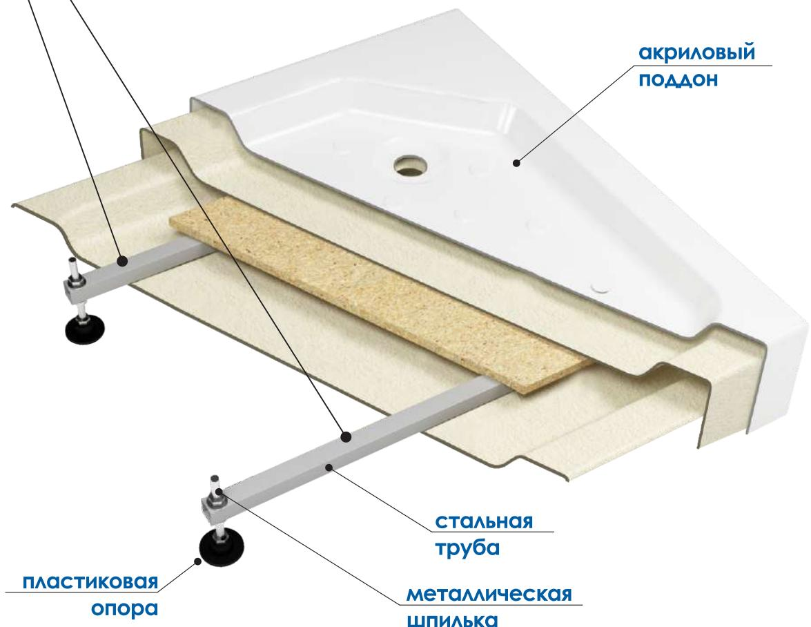
\*\*\*пластиковые опоры и металлические шпильки входят в монтажный пакет вместе с изделием
