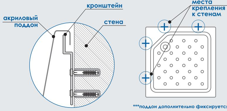
У акрилового душевого поддона предусмотрен **встроенный металлический каркас**, который **армируется слоем ПЕНОПОЛИУРЕТАНА** вместе с изделием.
