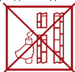
недостаточная тяга (Не используйте котел!)
