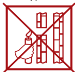
слабая тяга (Не используйте котел!)
