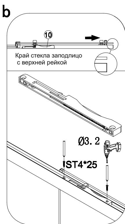
Второй расположен на верхней части неподвижной стеклянной профильной рамы на противоположном конце профиля, как показано на рисунке.
