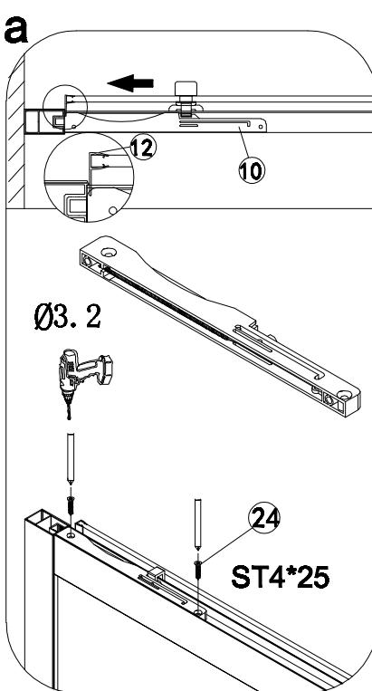
Первый поршень расположен в верхней части неподвижной стеклянной профильной рамы на стене и, как показано на рисунке.
