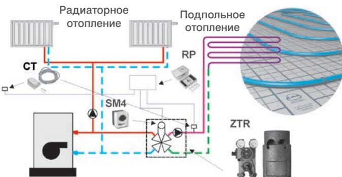
Смеситель KANBLOC (ZTR) дополнительно оснащенный сервоприводом (SM4), погодным регулятором (RP) и датчиками температуры (CT), реализуют автоматическое регулирование, например, в зависимости от наружной температуры.
