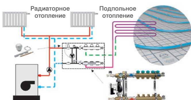
Распределители серии 73A и 77A подключаются непосредственно к радиаторному отоплению и представляют собой местную смесительную систему. Термостатическая головка с капиллярной трубкой играет роль защиты перед возможным ростом температуры, а также позволяет регулировать температуру, понижая ее от величины 55°C.
