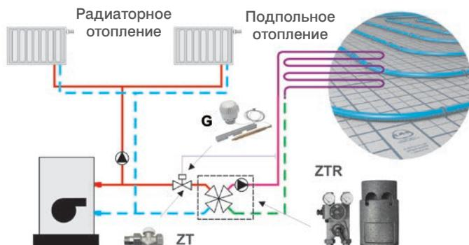
Смеситель KANBLOC с четырехходовым вентилем (ZTR), дополнительно оснащенный термостатическим вентилем (ZT) и головкой с накладным датчиком (G), реализуют полуавтоматическое регулирование.
