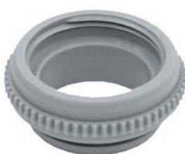
**Адаптер M30x1,5 для электрического сервопривода (серый цвет)** - используется для терmostатических вентиляй, например, на подаче распределителя со смесительной системой серии 73A, 73E, 77A, 77E а также для вентиляй на верхнем коллекторе распределителя N75A и N75E.
