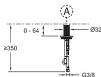
Спецификация продукта: Однорычажный смеситель для кухни с выдвижным изливом. 596D. Коллекция: SIMPLICE. Вес: 2,3 кг. Расход воды: 6 л/мин при давлении 3 бар. Высота под изливом: 405 мм. Механизм: Керамический картридж для смесителя 25 мм. Боковой рычаг для легкого управления.
