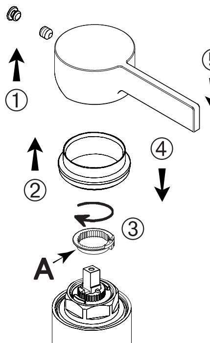
**F** Une bague-limiteur de température (**A**), clipsée sur la cartouche, permet de limiter le déplacement du levier vers la gauche, et de diminuer ainsi la température de l'eau chaude. (selon ①②③④⑤)
