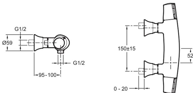
Спецификация продукта: Настенный термостатический смеситель для душа. E71683. Коллекция: SYMBOL. Вес: 3,7 кг. Расход воды: 18 л/мин при давлении 3 бар. Механизм: Термостатический картридж. Разметка отверстий: 150 ± 15 мм. Роскошь, элегантность, плавные линии. Обратный клапан в комплекте.
