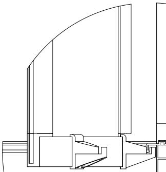
5. С внутренней стороны к направляющим каркаса шурупами прикрутите демпферы согласно нанесенной разметке (рис. 6).
