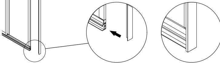
7. В установочном профиле просверлите три сквозных отверстия для крепления к стенам. Приложите установочный профиль к стене, нанесите разметку через просверленные отверстия (рис. 9). По разметке просверлите в стенах отверстия, установите в них дюбели (рис. 10).
